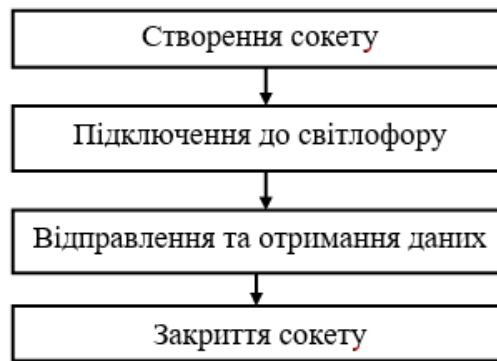
Рисунок 1 – Схема роботи блоку відправлення інформаційного повідомлення та отримання сигналу підтвердження
