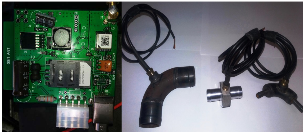
Рисунок 1 – Загальний вигляд елементів трекера та датчиків температури
