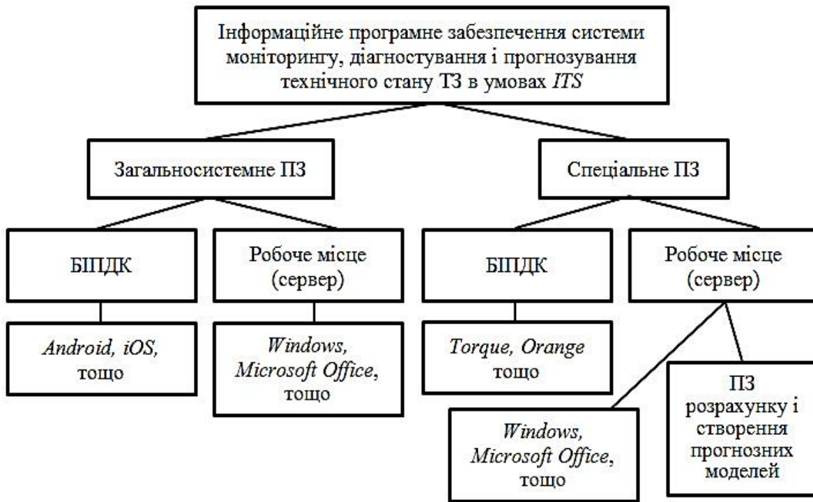
Рисунок 1 – Структура інформаційного забезпечення системи моніторингу, діагностування і прогнозування технічного стану автомобілів в умовах ITS
