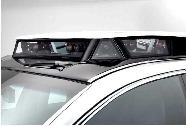
Рисунок 2 – Додаткові датчики безпілотного автомобіля Lexus P4
