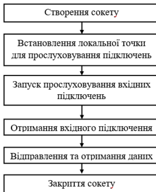
Рисунок 2 – Схема роботи блоку отримання та передачі сигналу
