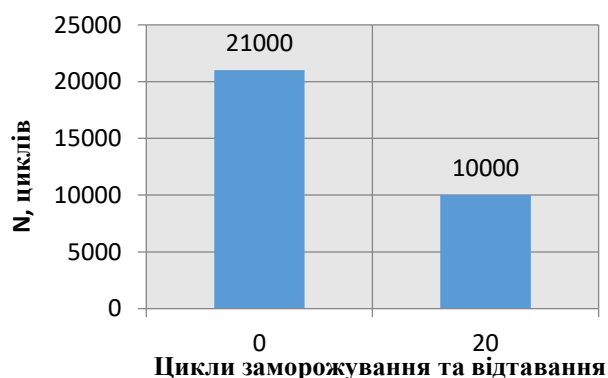
Рисунок 2 – Залежність втомної довговічності асфальтобетону від кількості циклів заморожування-відтавання [8]
