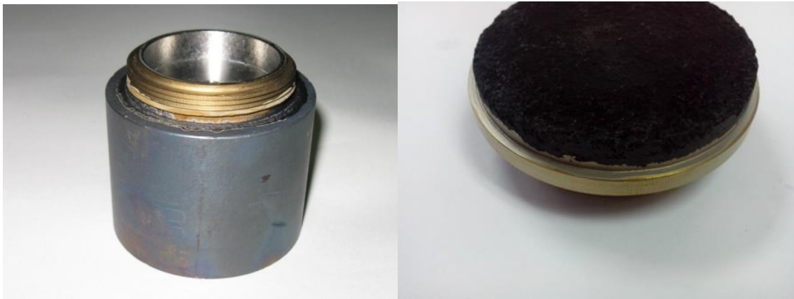
Рисунок 8 - Фотографія молибденового (а) і графітового (б) катода, спаяного з титановою різьбовою частиною мідним припоєм
