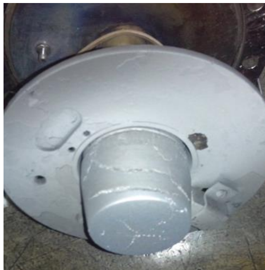
Рисунок 1 - Фотографія паяного хромового катода з тріщинами
