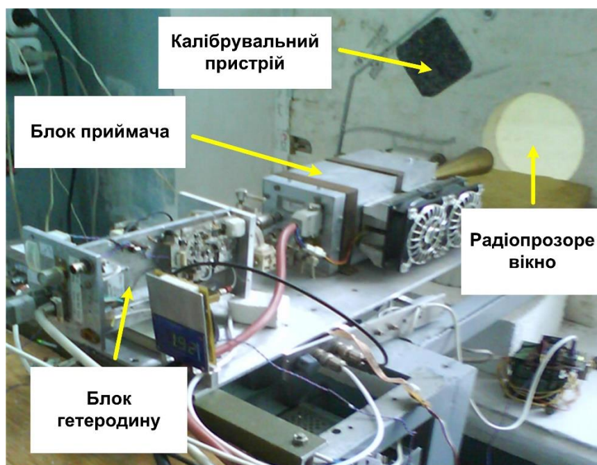
Мал. 2. Зовнішній вигляд приймальної системи спектро радіометра надвисоких частот.
