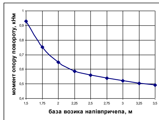
Рисунок 6 – Залежність моменту, що діє на возик тривісного напівпричепи при русі криволінійною траєкторією, від його бази
