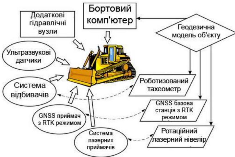
Рисунок 1 – Схема системи автоматичного нівелювання для грейдерів і бульдозерів
