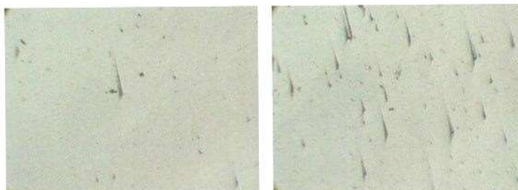
Рис. 1. Неметалеві включення при наплавленні без модифікування \times 100
