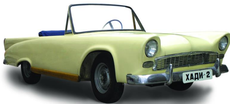
Рис. 8.33. Перший в СРСР автомобіль зі склопластиковим кузовом «ХАДІ-2»
