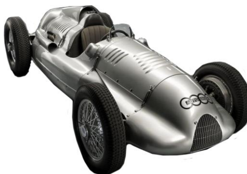
Рис. 8.14. Автомобіль для перегонів «Авто-Уніон» (16-циліндровий, 3 л) типу GP, 1939 р.
