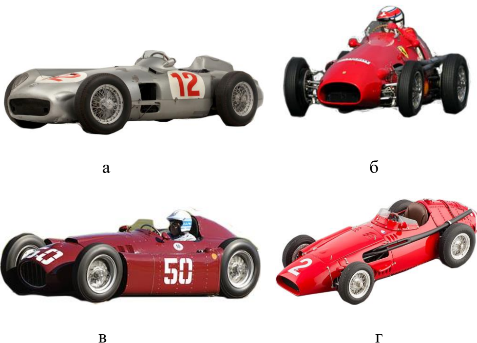
Рис. 8.16. Автомобілі для перегонів з двигуном 2,5 л: а – «Мерседес-Бенц» (8-циліндровий); б – «Феррарі» (4-циліндровий); в – «Лянчіа» (8-циліндровий); г – «Мазераті» (6-циліндровий)
