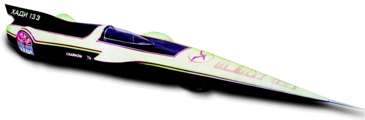
Рис. 8.40. Рекордно-перегоновий електромобіль «ХАДІ-13Е»
