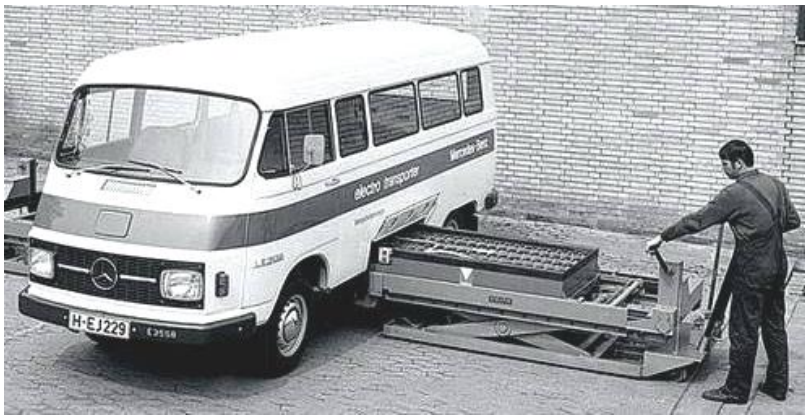
Рис. 7.16. Заміна батареї на електромобілі фірми «Mercedes»
