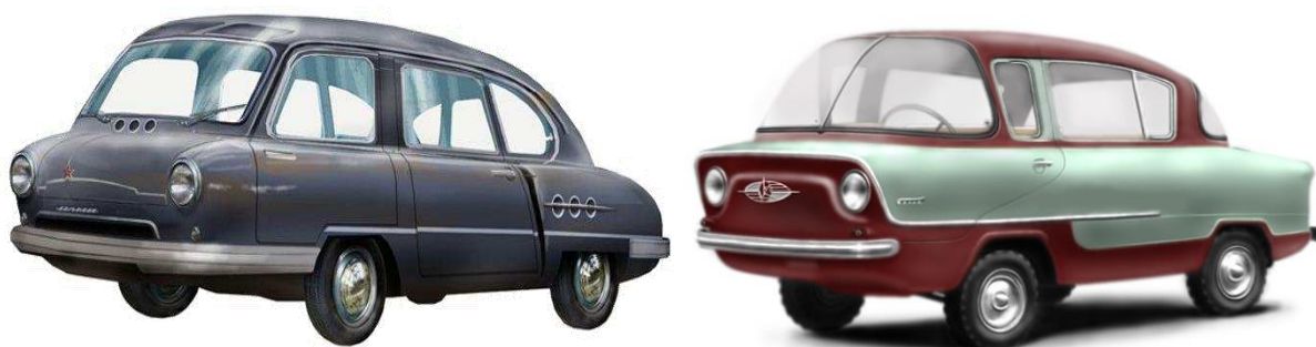
Рис. 2.38. Перші у світі легкові автомобілі вагонного компонування (НАМІ-013 та НАМІ А50 «Білка»)
