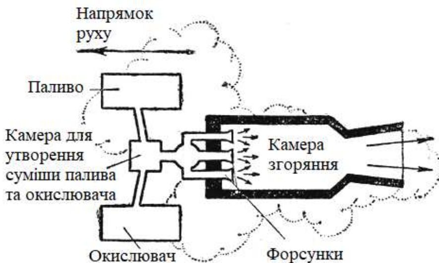
Рис. 5.18. Схема рідинного реактивного двигуна
