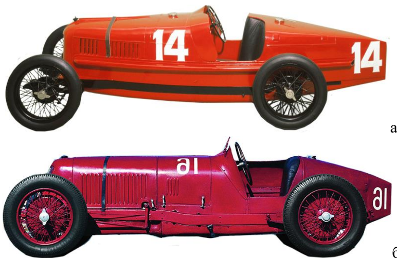
Рис. 8.10. Автомобілі для перегонів у формулі 1922–1927 рр.: а – «Фіат 804» 1922 р. (6-циліндровий, 2 л); б – «Далаж» 1927 р. (8-циліндровий, 1,5 л)
