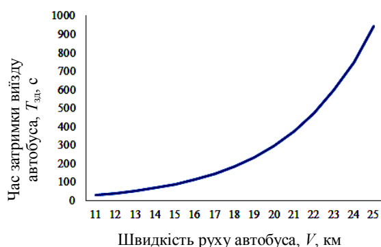
Рис. 1. Залежність часу затримки виїзду автобуса із зупинки від швидкості потоку
