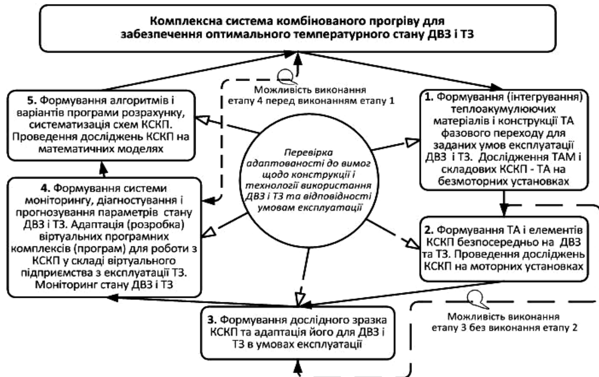
Рис. 3. Формування і дослідження комплексних систем комбінованого прогріву для забезпечення оптимального температурного стану ДВЗ і ТЗ
