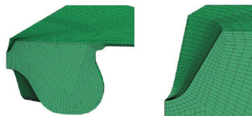
Рис. 4. Расчетная сетка, описывающая фрагмент камеры сгорания для моделирования рабочих процессов дизеля в осесимметричной постановке [13]
