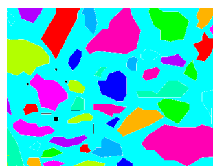
Рис. 2. Фотографія поверхні розрізаного асфальтобетонного зразка та зображення двовимірної геометричної моделі асфальтобетону
