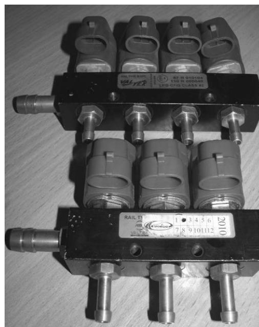
Рис. 2. Электромагнитные дозаторы «Valtek»
