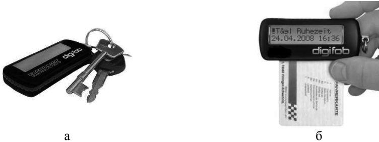
Рис. 6.20. Digifob – прилад для контролю за режимом роботи водія: а – загальний вигляд; б – пристрій у роботі
