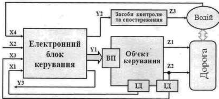
Рис. 7.49. Узагальнена функціональна схема системи «автомобіль-водій-дорога»:
