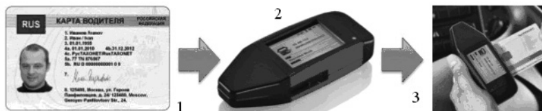
Рис. 6.17. Зчитування даних с карти с допомогою завантажувача:
