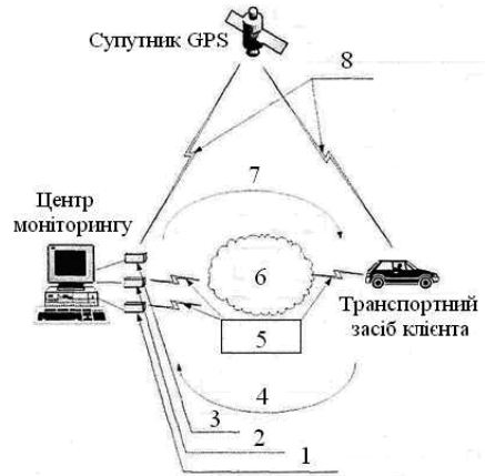
Рис. 6.25. Схема корпоративного центра моніторингу мобільних об'єктів:
