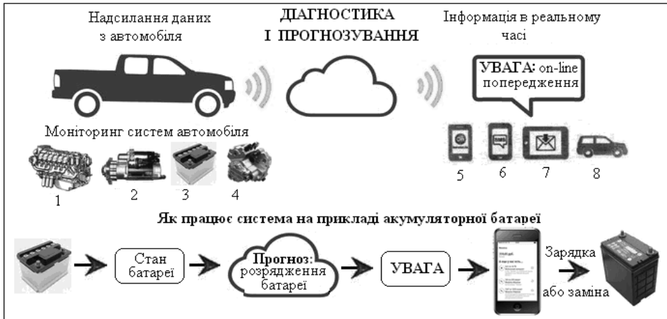
Рис. 7.22. Технологія Proactive Alerts для діагностування та прогнозування технічного стану:
