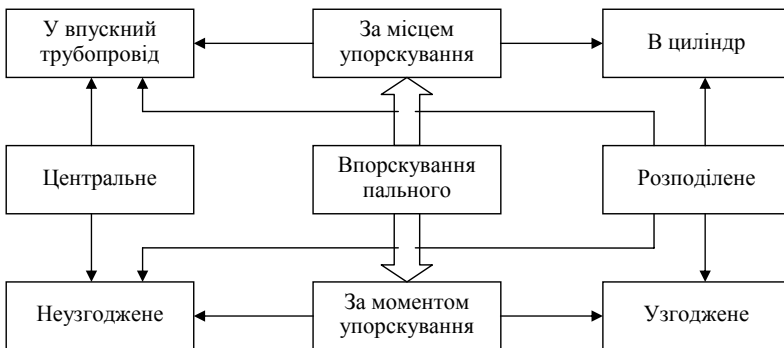
Рис. 7.51. Класифікація способів упорскування пального
