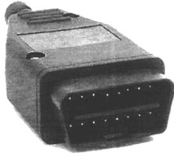
Рис. 7.15. Вид конектора діагностичного рознімача J1962 стандарту OBD-II
