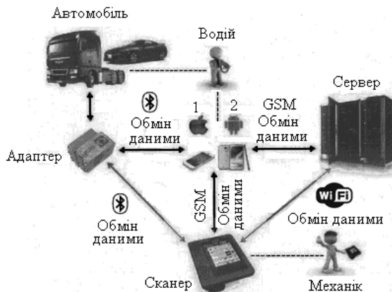
Рис. 7.20. Дистанційна комп'ютерна діагностика автомобіля:
