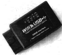
Рис. 7.17. Вид гаджетів-адаптерів OBD-II з різними способами підключення до зовнішнього пристрою:
