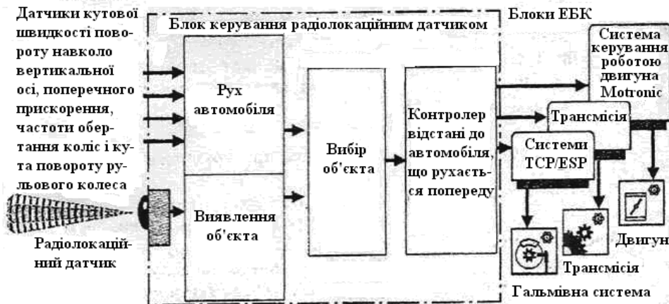
Рис. 7.25. Основна структура керування системи ACC
