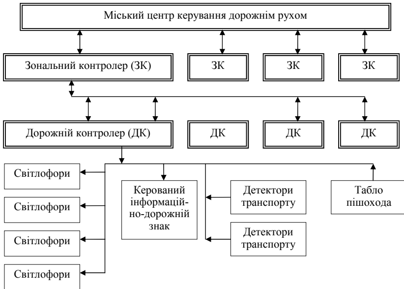
Рис. 4.18. Ієрархічна структура системи керування дорожнім рухом
