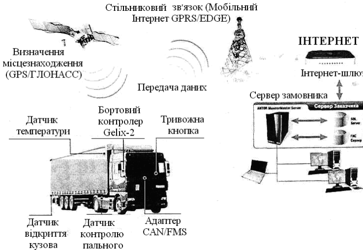
Рис. 6.23. Загальна структура трекінгових систем реального часу
