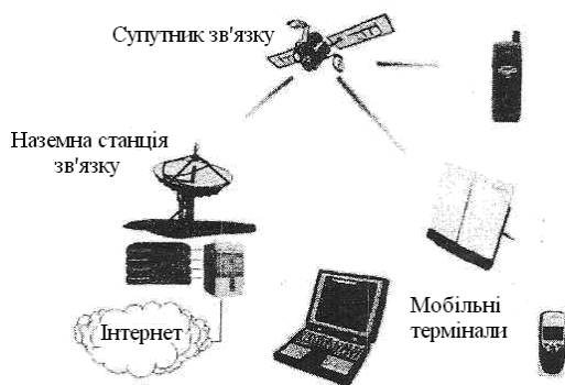
Рис. 6.22. Схема супутникової мобільної радіосистеми
