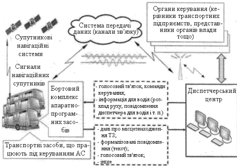
Рис. 8.5. Принципова схема роботи АС пасажирськими перевезеннями на базі супутникової навігації
