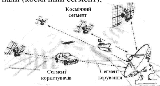
Рис. 5.2. Загальна схема структури супутникової навігаційної системи
