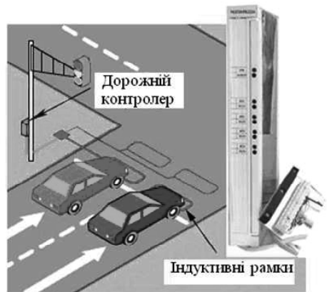
Рис. 4.10. Схема встановлення індуктивних детекторів
