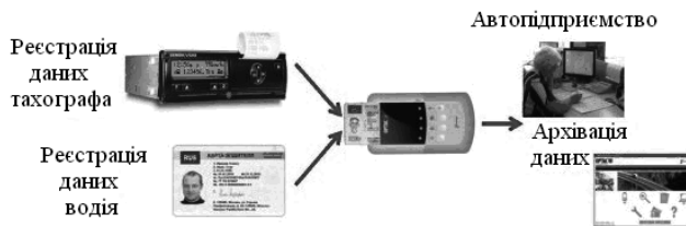
Рис. 6.13. Схема використання даних у системі транспортного моніторингу
