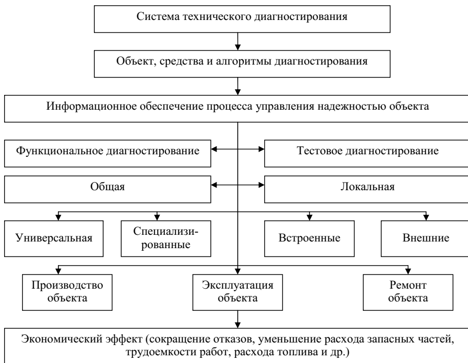
Рис. 5.6. Схема системы технического диагностирования
