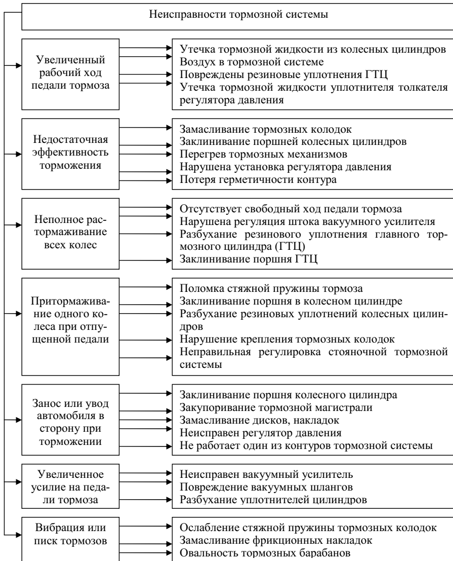
Рис. 4.7. Неисправности гидравлической тормозной системы
