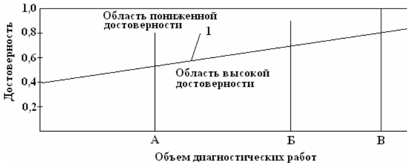
Рис. 4.11. Схема вероятностной достоверности оценки технического состояния объекта диагностирования органами чувств человека
