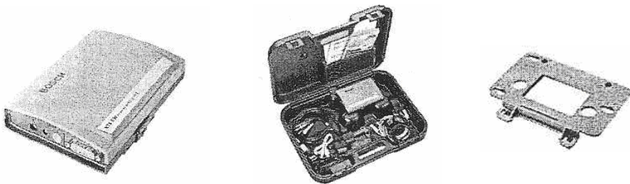
Рис. 5.12. Системный сканер KTS 530 с комплектующими
