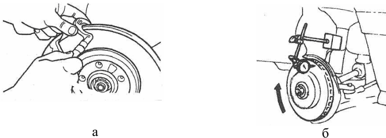
Рис. 2.3. Контроль толщины (а) и биения (б) тормозного диска
