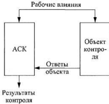
Рис. 2.6. Схема функционального контроля с использованием АСК
