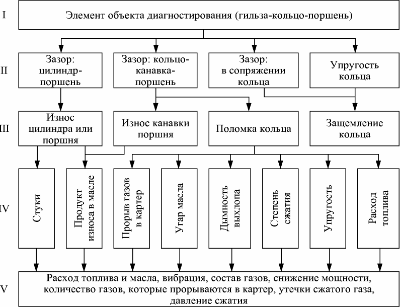
Рис. 3.4. Структурно-наследственная диагностическая модель цилиндропоршневой группы двигателя
