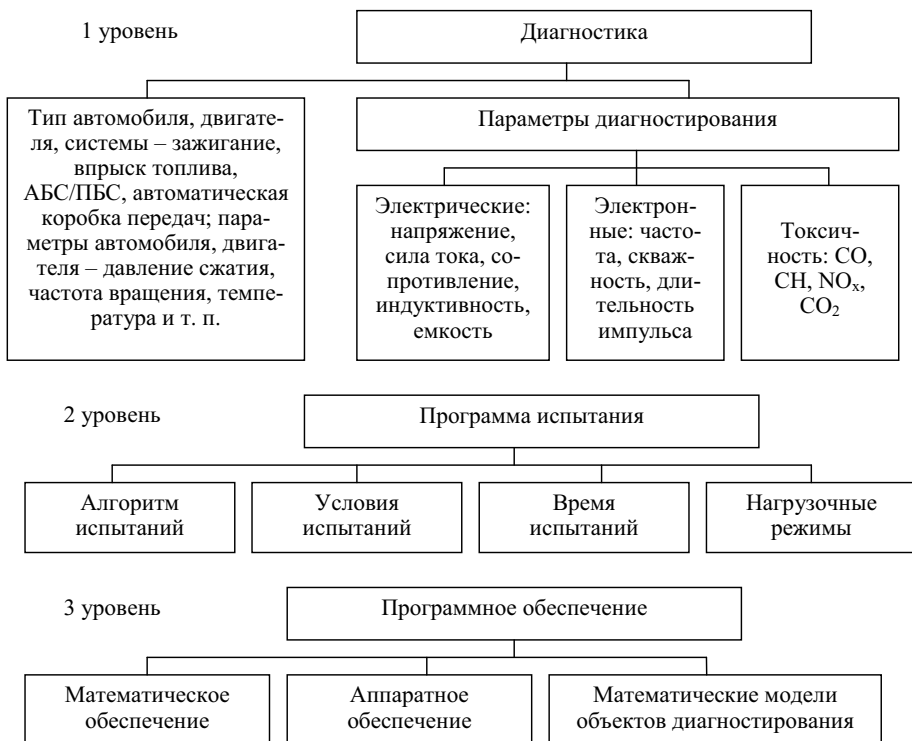
Рис. 5.10. Структура управления и программного обеспечения мотор-тестера
