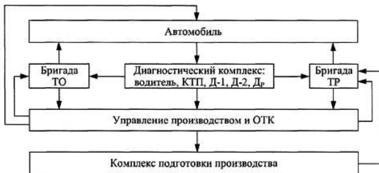
Рис. 2.19. Схема использования диагностирования для оперативного управления ТО и ТР на АТП
