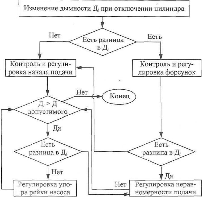
Рис. 3.21. Алгоритм диагностирования топливной аппаратуры при высокой дымности выпускных газов
