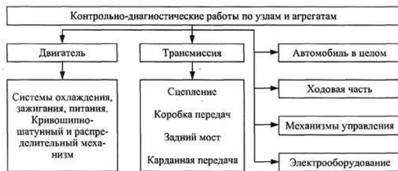
Рис. 2.24. Схема контрольно-диагностических работ агрегатов при ТО автомобиля
