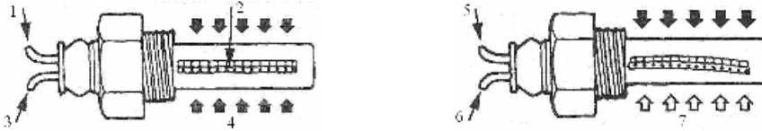
Рис. 2.9. Принцип перетворення виконавчим механізмом електричного сигналу електронного блока керування у механічний сигнал:
