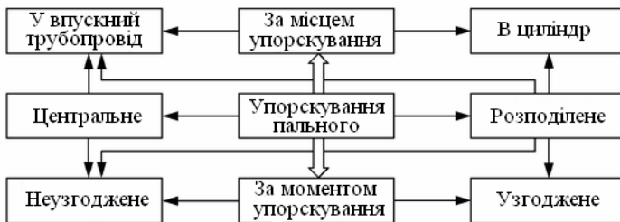
Рис. 5.2. Класифікація способів упорскування пального
