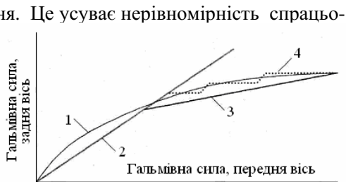
Рис. 8.15. Електронне керування гальмівними силами:
