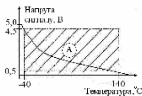
Рис. 11.26. Контрольована блоком керування напруга сигналу датчика з від'ємним температурним опором (NTC):
