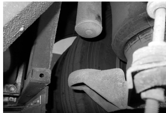
Рис. 5. Обірваний шток амортизатора задньої підвіски
