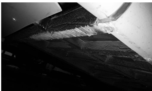
Рис. 3. Пошкодження поперечини в задній частині кузова
