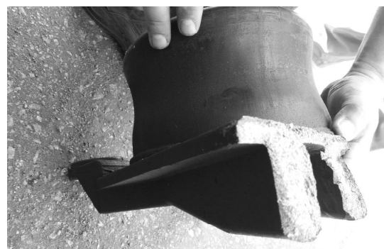
Рис. 6. Обламаний упор пневморесори задньої підвіски
