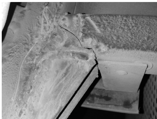
Рис. 9. Тріщина труби каркаса основи кузова в передній частині
