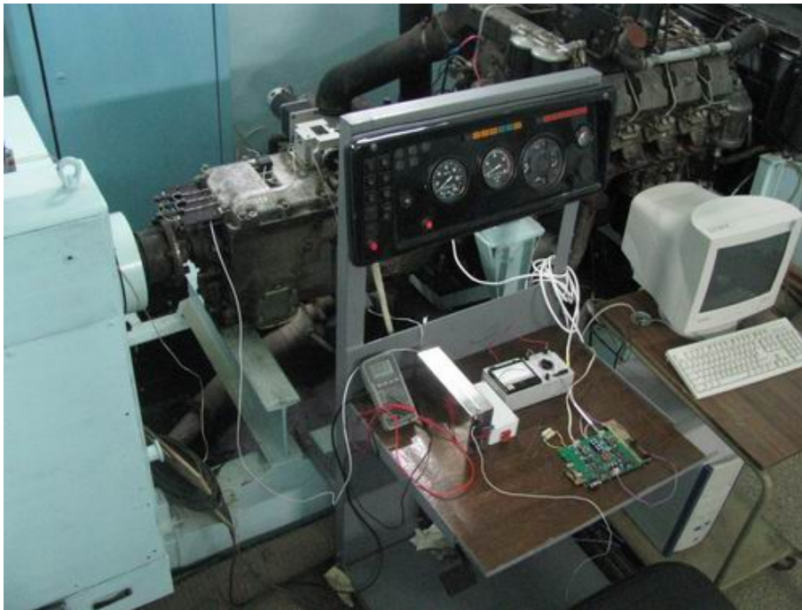
Рис. 7.1. Обладнання стенду робочим місцем оператора та вимірювальними пристроями
