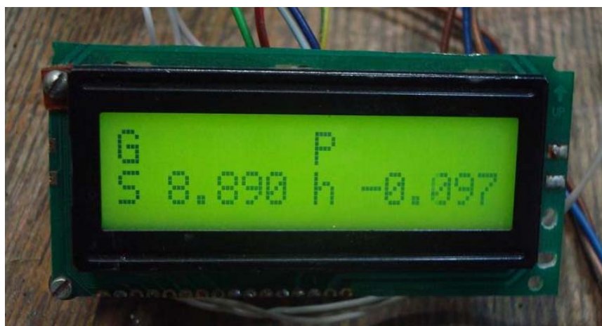
Рис. 8.3. Цифрове табло положення штока ЕППЗ
