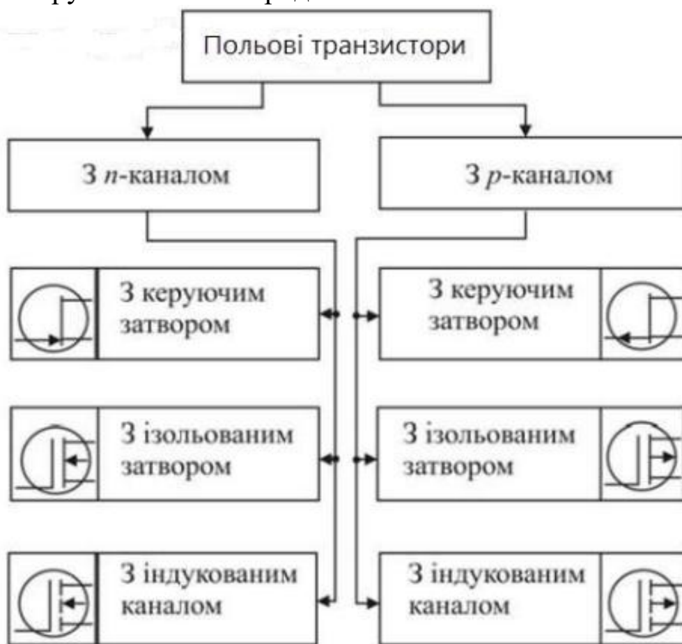
Рисунок 1.1 – Класифікація і умовні позначення польових транзисторів
