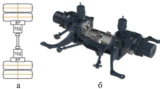
Рис. 13. ЕТПр з електромеханічним ВМ інтегрально-портального типу з двома ТЕД: а – компоновальна схема; б – електромеханічний ВМ «AxleTech Proterra-eAxle» [4]
