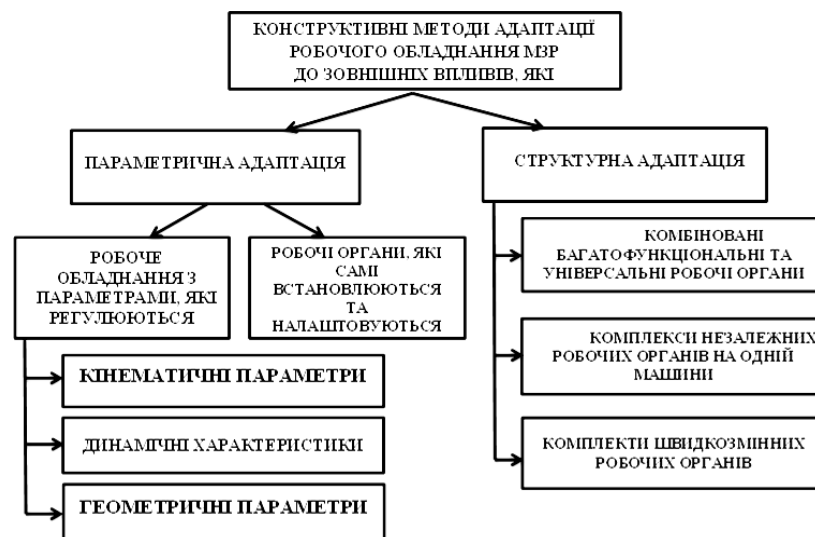
Рисунок 1 – Класифікація конструктивних методів адаптації робочого обладнання МЗР до зовнішніх впливів, які змінюються
