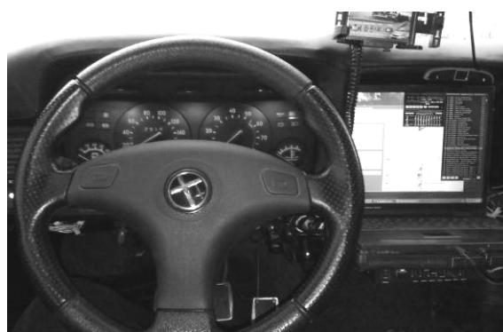
Рис. 1. Компьютерный модуль, интегрированный в переднюю панель автомобиля
