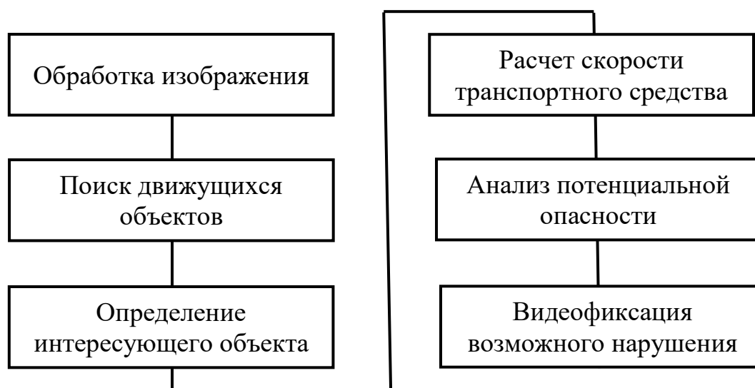
Рисунок 1 – Структурная схема системы видеофиксации нарушения
