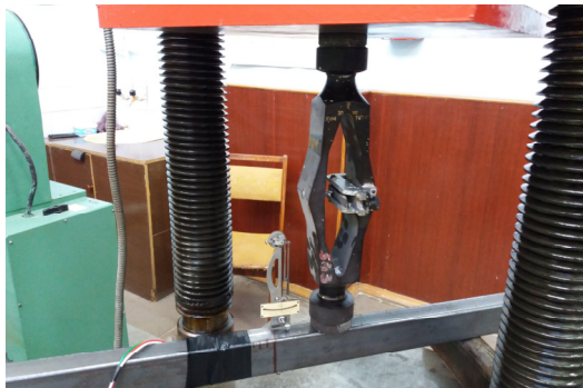
Рис. 4. Перевірка працездатності тензостанції в лабораторних умовах
