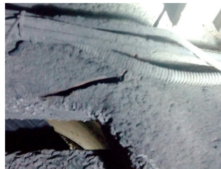
Рис. 12. Тріщина каркаса основи автобуса
