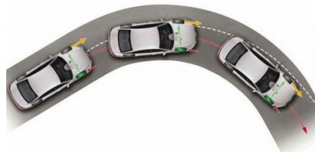
Рис. 3. Система розподілу гальмівних зусиль [13]
