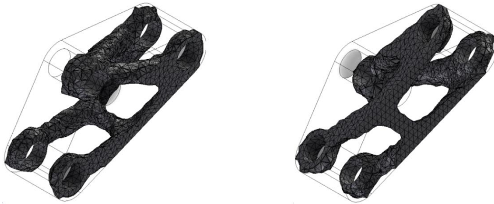
Рисунок 5 – Пропонована конструкція №4: 17,6 кг. Зниження ваги: 81%
