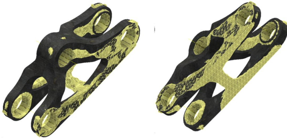
Рисунок 8 – Геометричне порівняння генерованої форми с проектованою деталлю
