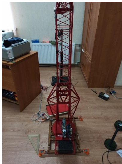
Рисунок 2 – Експериментальна установка – модель крану
