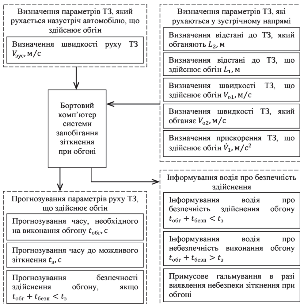
Рис. 5. Структурна схема роботи системи запобігання зіткненню автомобілів при русі ТЗ назустріч автомобілю, що здійснює обгін
