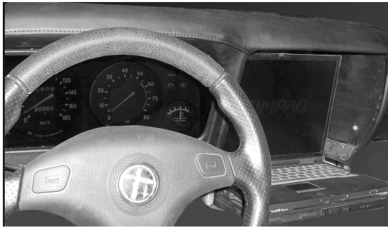
Рис. 1. Установленный компьютер в модернизированной торпеде автомобиля ВАЗ 2101
