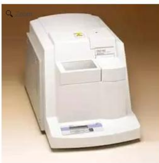
Рисунок 10.2. Диференціальний скануючий калориметр Shimadzu DSC-60
