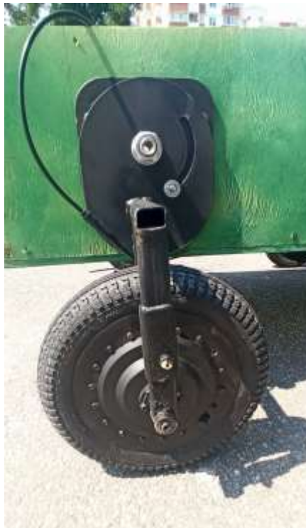
Рис. 3 – Мотор-колесо безкіпажного колісного візка з електроприводом
