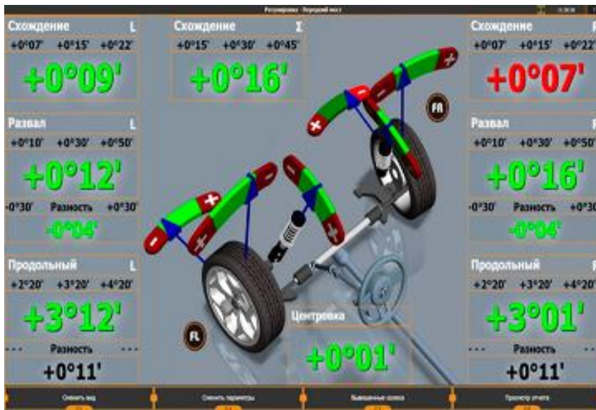
Таблиця 1 – Характеристика стану BOSCH серії FWA для встановлення кутів коліс
