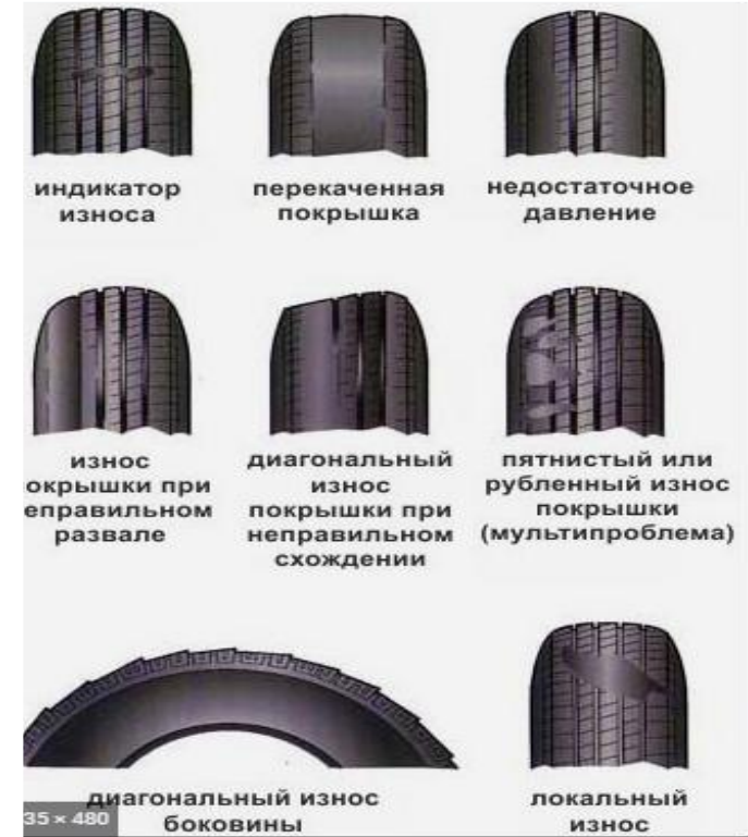
Рисунок 1 - Типові приклади зносу шин при неправильній експлуатації
