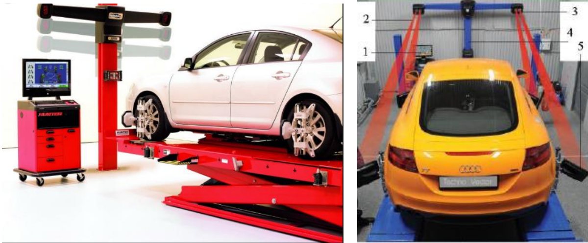
1 – комп'ютер; 2 – лазерний промінь; 3 – камера; 4 – стійка; 5 – мішень Рисунок 2.7 - Загальний вид станда з використанням 3D технологій.
