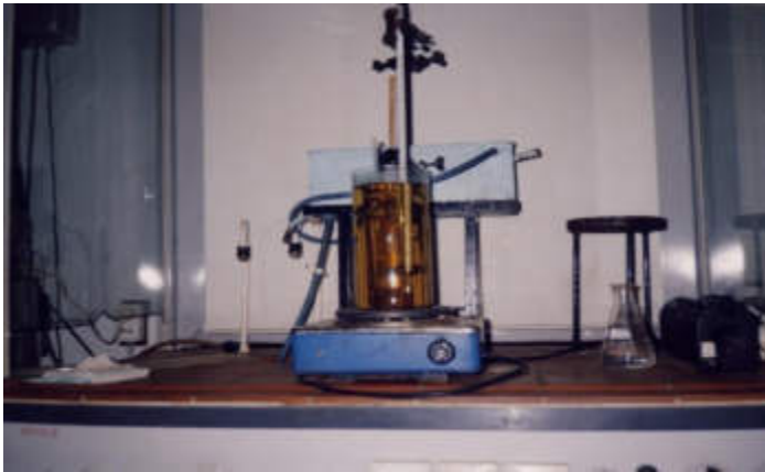
Рисунок 11 – Прилад для визначення кінематичної в'язкості
