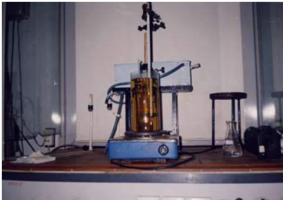
Рисунок 4.4 – Прилад для визначення кінематичної в'язкості
