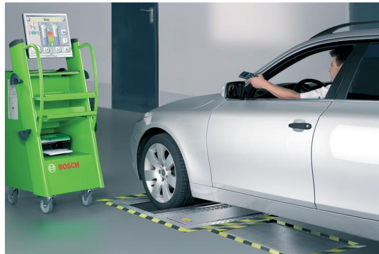
Рисунок 12 - Установка автомобіля на робочі ролики стенда BSA-4341
