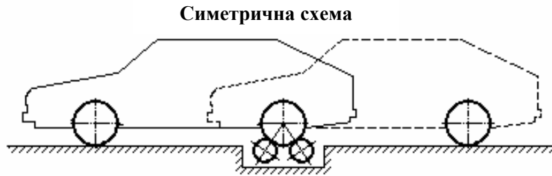
Рисунок 5 - Варіанти розташування роликів одновісного роликівого стенду
