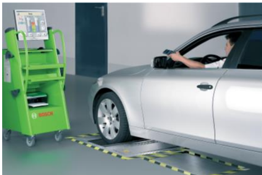
Рисунок 4.2 – Установка автомобіля на робочі ролики станда BSA-4341
