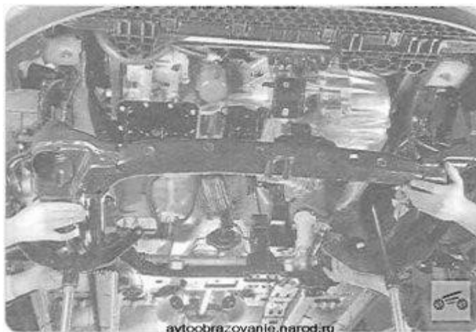
Рисунок 4.3 – Підрамник передньої підвіски у зборі з рульовим механізмом
