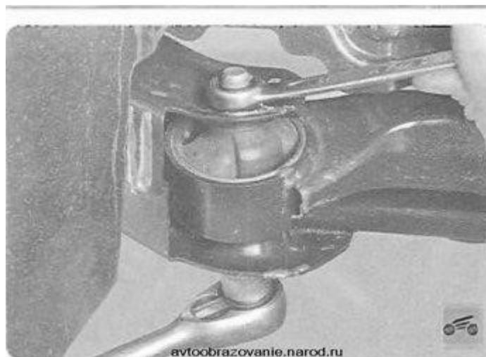
Рисунок 1.1- Болти кріплення корпусу кульової опори до поворотного кулака
