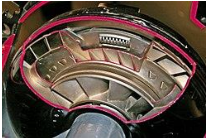
Рисунок 3.3 – Вигляд гідротрансформатора коробки передач ZF 8HP
