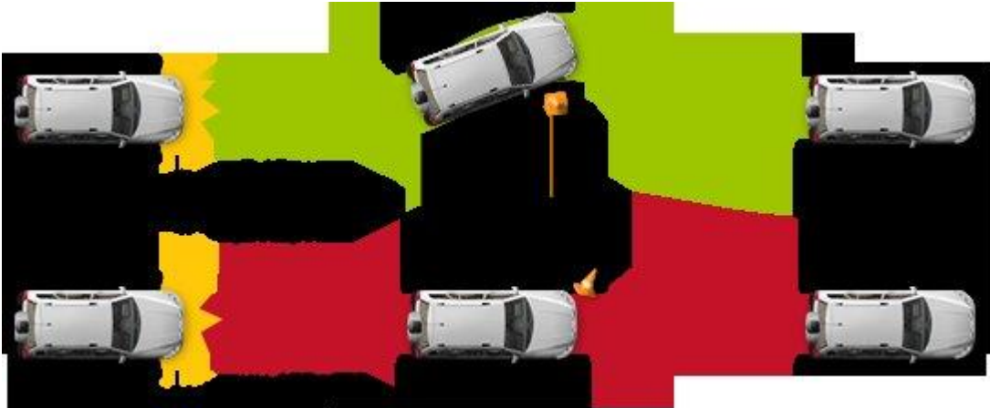
Рисунок 1.3 – Схема керування автомобілем з EBD [13]
