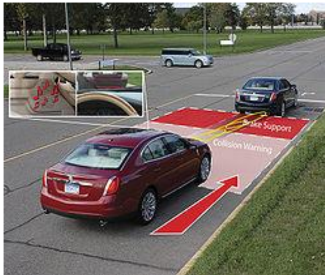
Рисунок 1.5 – Схема роботи системи екстреного гальмування (Brake Assist)
