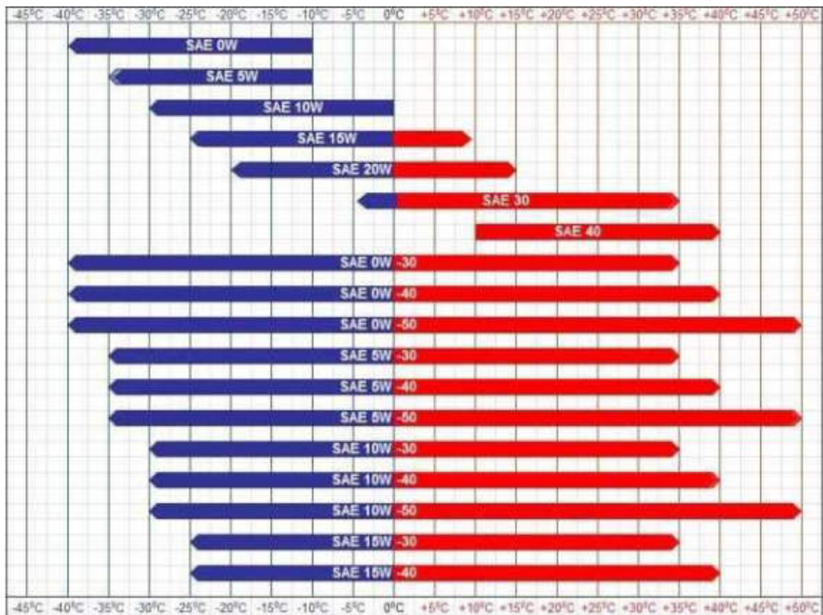
Рисунок 2.2 – Діаграма залежності в'язкості оливи по SAE від температури повітря
