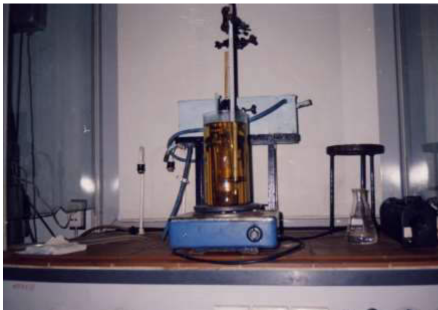
Рисунок 5.2 – Прилад для перевірки кінематичної в'язкості
