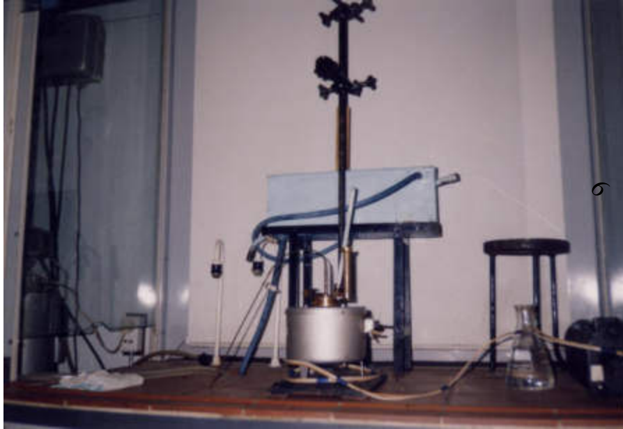
Фото 1 – Прилад для перевірки температури спалаху
