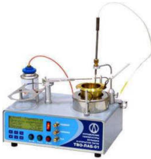
Рисунок 2.6 – Апарат для визначення температури спалаху у відкритому тиглі
