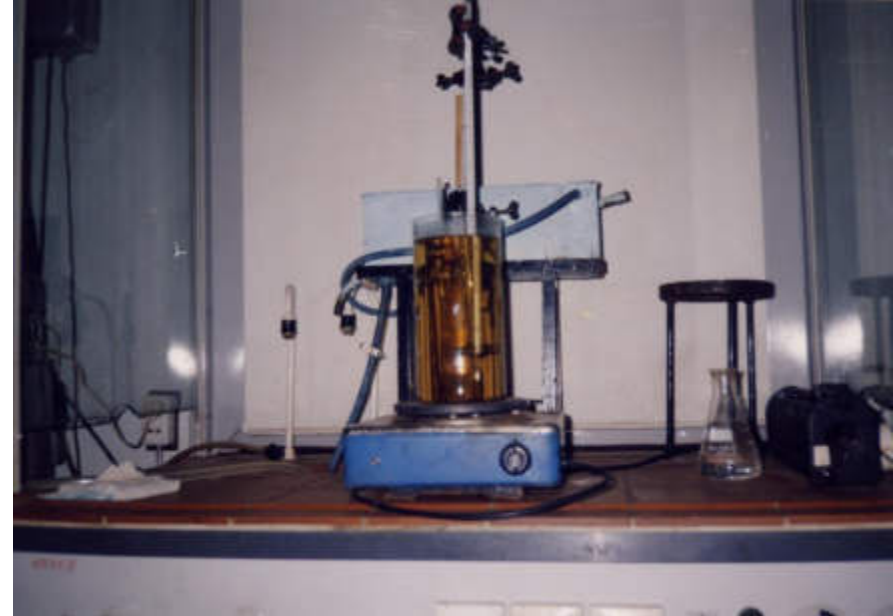
Фото 2 – Прилад для перевірки кінематичної в'язкості
