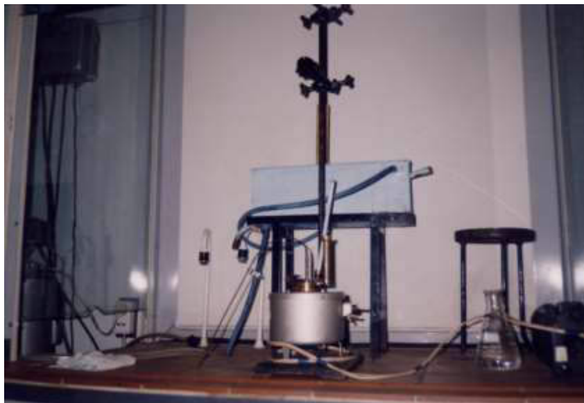
Рисунок 5.4 – Прилад для перевірки температури спалаху оливи
