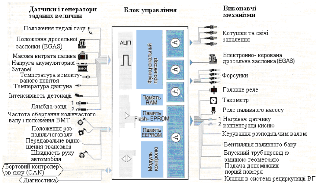
Рисунок 5 – Компоненти електронного управління і регулювання в системі ME-Motronic
